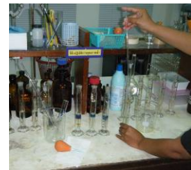
รูปที่ 5 วิเคราะห์สารฟอสเฟตด้วยวิธี Ascorbic method
