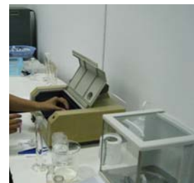
รูปที่ 6 วัดค่าดูดกลืนแสงด้วยเครื่องสเปกโตรโฟโตมิเตอร์
